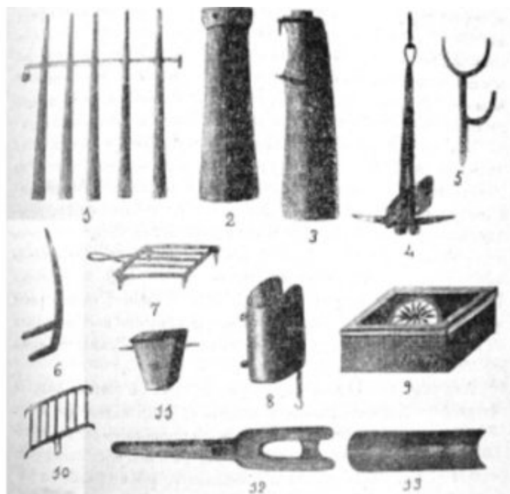
Provincia de Santander. -- Enseres curiosos de las embarcaciones de pesca: 1, remos atravesados con una barra de hierro, cerrada con un candado, para evitar que los roben de las embarcaciones; 2, orza para colocar al costado de sotavento cuando se navega 3 la vela con viento fre-co; 3, tim3n de las traineras; 4, potada, especie de arpeo con dos palos y una piedra, sirve para fond ar en donde hay roca por si hay que picar el cabo que lo sujeta y perderlo, y asi se pierde menos que si fuese el arpeo; 5, horquilla de hierro doble para colocar en el costado de las lanchas de bonito y descansar en ellas las alas 3 varas por las cuales pasan los aparejos de pesca; la baja sirve para barlovento y la alta para sotavento; 6, aguja del tim3n; 7 y 10, claves de parrillas usadas en las lanchas del bonito para asar la pesca; 8, guarda aguja 3 defensa que se coloca en la aguja, 3 fin de que esta no se cierre con los golpes 3 embestidas que reciben unas de otras en los puertos que no son muy seguros; 9, aguja 3 comp3s de gobernar, dentro de su caja; 11, cu3a para calzar el palo mayor una vez izado, 3 fin de que no se mueva; 12, gaviote para colocarlo en la roda de proa y pasar por 6 el cabo del arpeo y levarlo; la soldana de madera que tiene es muy gruesa y fuerte; 13, tarrieta, trozo de madera hueco por dentro, que se coloca en la borda y corren por 6 los aparejos sin romperse.
